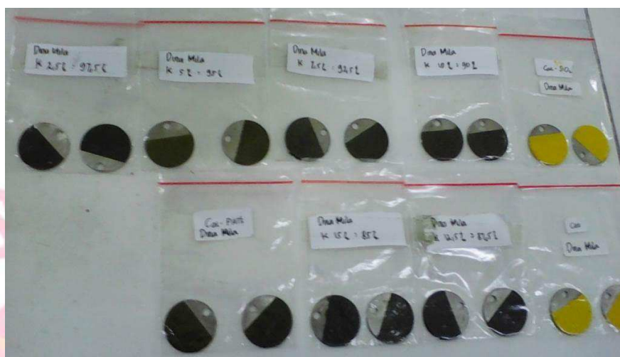
Gambar 1. Cat-PANi/ \text{SiO}_2 terlapiskan pada permukaan Baja SS304, untuk variasi komposisi PANi: \text{SiO}_2
